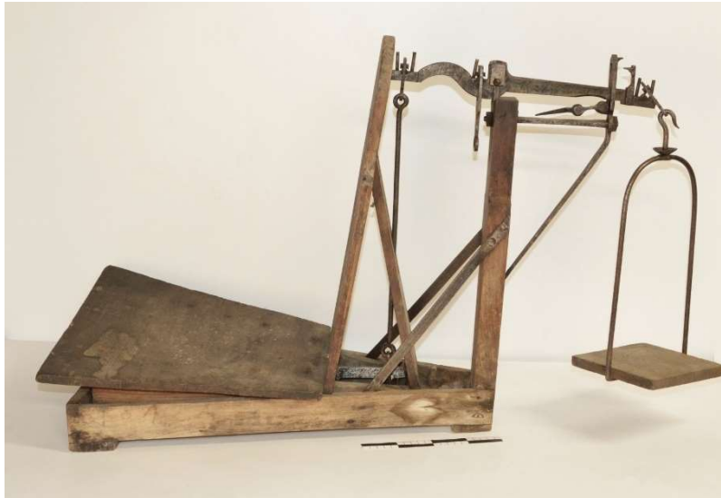
Record AVD1421 – Bascule van een loodgieter om lood te wegen © Provinciebestuur West-Vlaanderen
