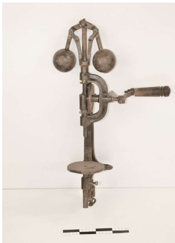
Record 730 – Kolomboormachine met centrifugaalregelaar © Provinciebestuur West-Vlaanderen
