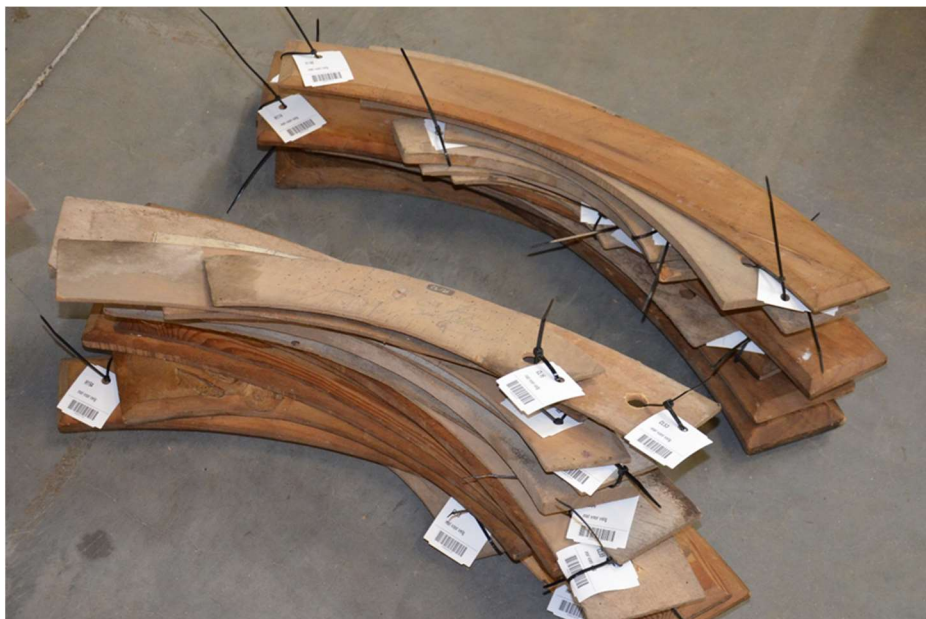
Reeks mallen voor velgsegmenten uit de wagenmakerij, met barcodelabel © Provinciebestuur West-Vlaanderen
