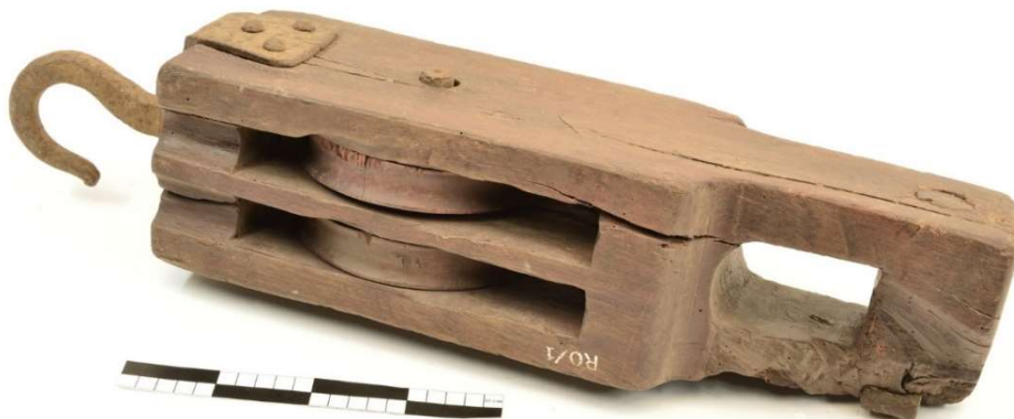
Record RO1 – Hijsblok uit Beernem met twee katrolschijven, uit 1860 © Provinciebestuur West-Vlaanderen
