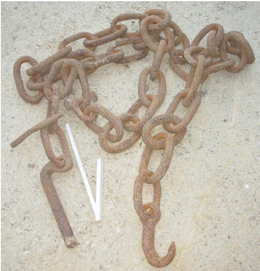
Fotoreeks: Het principe van de werking van de slijphaak. De schakels hebben een lengte van ongeveer 20 cm. De ketting heeft aan één uiteinde een haak en aan het andere einde een slijphaak. Tussenin is er nog een verbinding met een shackle. (Boomketting van de euts van Herman Deridder.)
