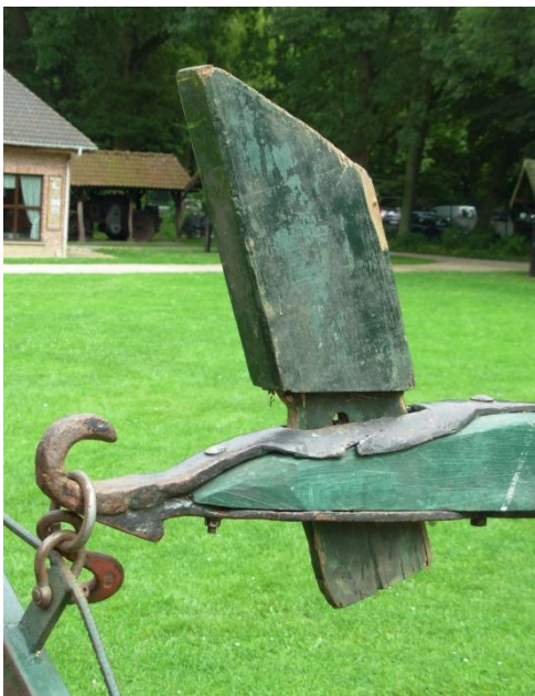
Linksboven: Bij een geladen boomezel wordt de sleepvoet omgedraaid meegevoerd. (inv.12) Links- en rechtsboven (inv. 5): disselgleuf met sleepvoet. Rechts: Alleen een disselvoetbeugel. (inv. 10)
