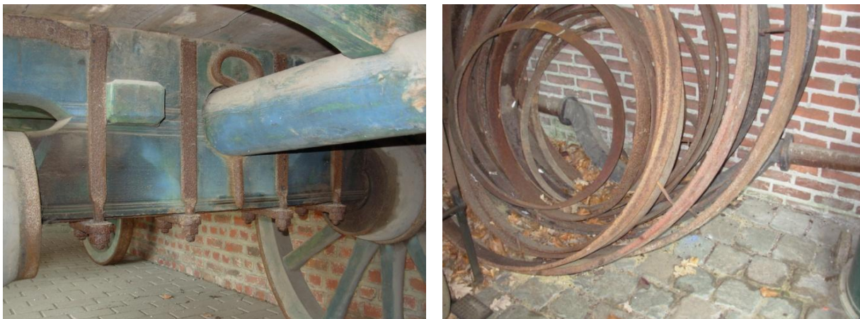
Links: Achterasblok van een West- Vlaamse wagen. Let op de doorstekende langboom met borgpen, de kop van de linker schoor en de vier beugels. De beugelmoeren zitten onderaan. Collectie MOT Tommenmolen te Grimbergen. Rechts: Vetas van een boomezel. Karrenmuseum Essen.
