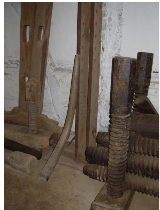
Foto's: Openluchtmuseum Cloppenburg. In het atelier van de timmerman staat in het midden een "Heblade" tussen de stutten van een zaagstelling, onderdelen van blokvijzels (Hausschrauben of Bauschrauben) en de as van een kaapstander. Foto's Luc V. 2007
