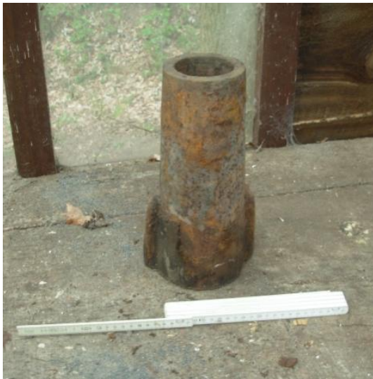
Links: Naafbus van een zware vetas.(Essen) Rechts: Geschrante spaakopstelling. (inv. 11)
