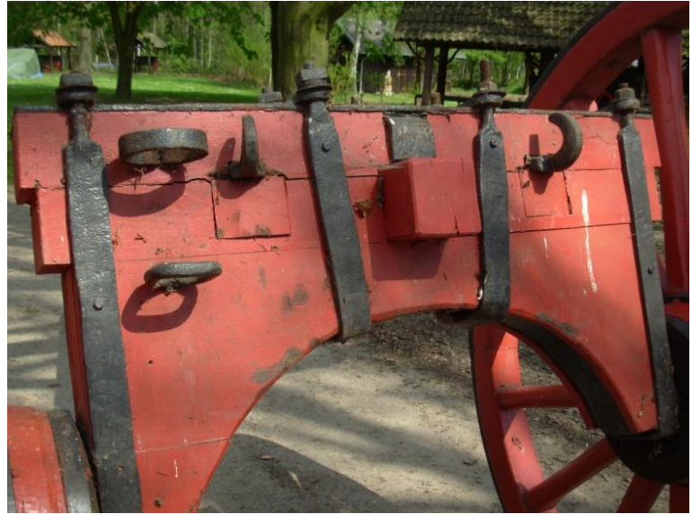
Links: Let op de ijzeren lat boven de asblok, de aanzet van de twee haken op de schoren, de ijzeren lat op de dissel en de beugel rond dissel en schoren. (inv. 1) Rechts: Haken op de schoren. (inv. 13)
