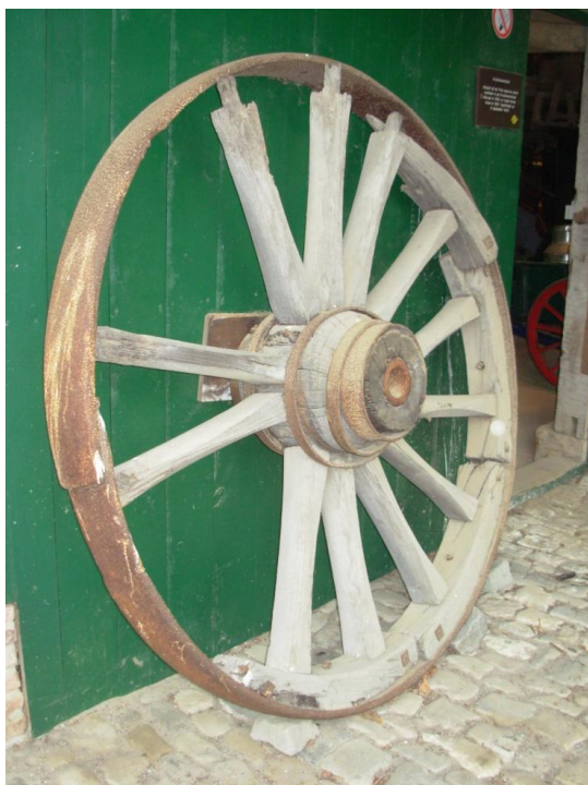
Restant van een boomezel: velgbreedte: 15 cm, wieldiameter: 173 cm, aantalspaken: 14 Heemmuseum De Botermolen te Keerbergen.
