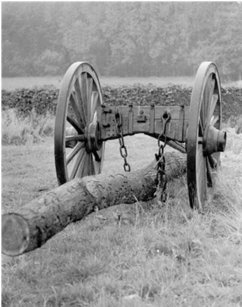
Boomezel uit Klein- Brabant met 16 spaken. Links achter twee laadhoutbeugels; op de schoren door de asblok heen zitten twee haken en onder deze haken is er telkens een beschermplaat tegen kettingsleet. Foto Jos Winckelmans
