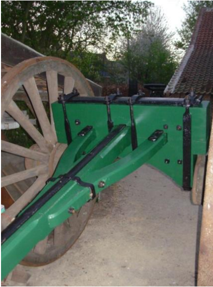
Links: Let op de ijzeren lat boven de asblok, de aanzet van de twee haken op de schoren, de ijzeren lat op de dissel en de beugel rond dissel en schoren. (inv. 1) Rechts: Haken op de schoren. (inv. 13)
