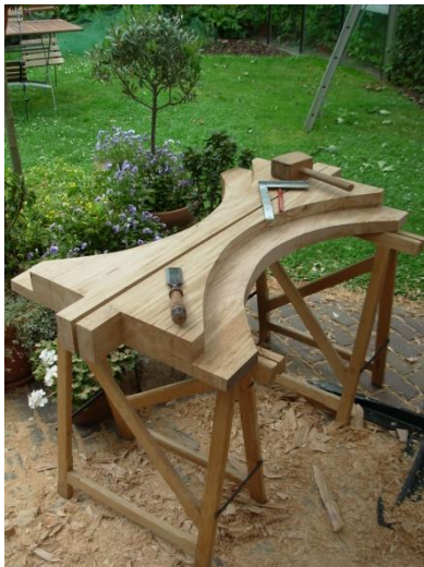
De vervaardiging van de asblok.
