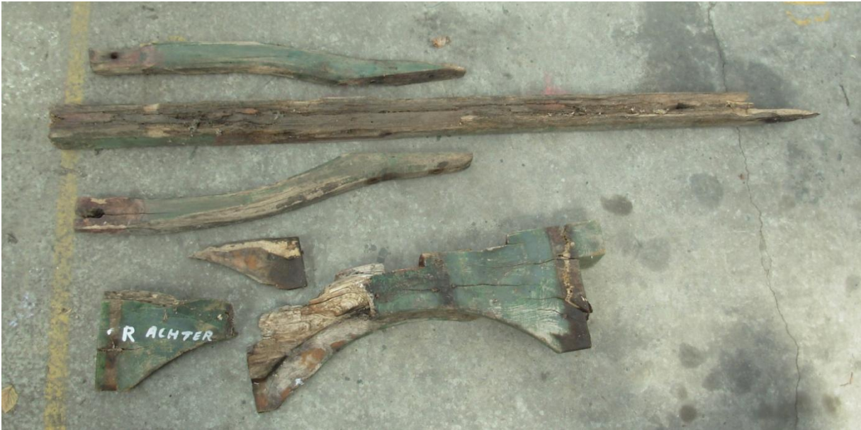
De oude onderdelen: de twee eiken schoren, de dissel en de onderhelft van de tweedelige olmen asblok.
