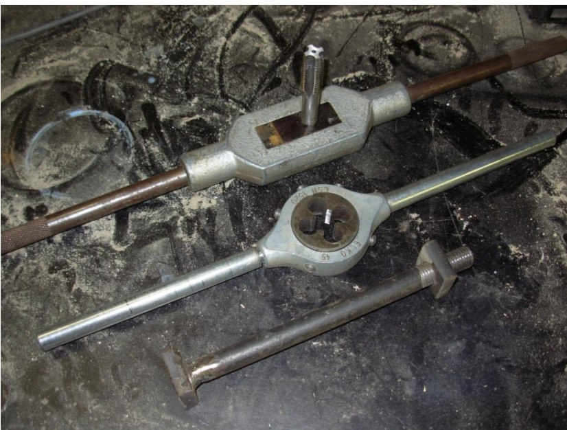
Snijden van draad met een snijkussen en tappen van draad in een moer met een draadtap.
