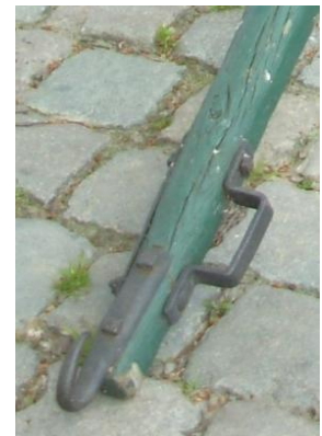
Linksboven: Bij een geladen boomezel wordt de sleepvoet omgedraaid meegevoerd. (inv.12) Links- en rechtsboven (inv. 5): disselgleuf met sleepvoet. Rechts: Alleen een disselvoetbeugel. (inv. 10)
