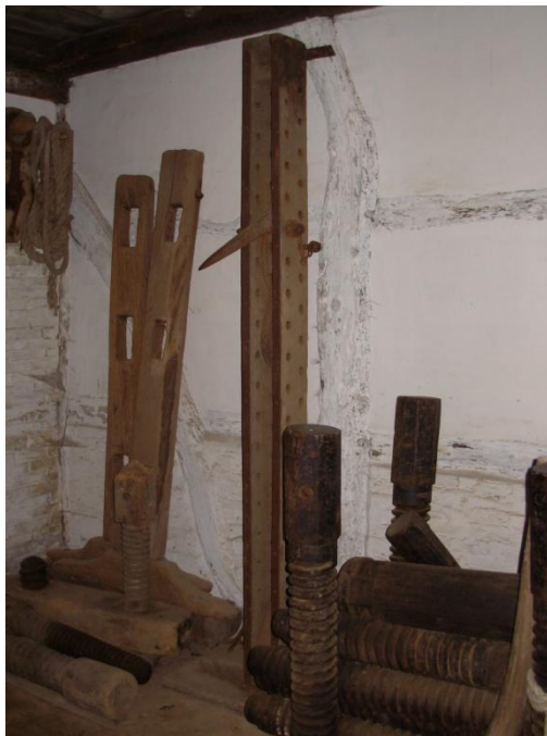
Foto's: Openluchtmuseum Cloppenburg. In het atelier van de timmerman staat in het midden een "Heblade" tussen de stutten van een zaagstelling, onderdelen van blokvijzels (Hausschrauben of Bauschrauben) en de as van een kaapstander. Foto's Luc V. 2007
