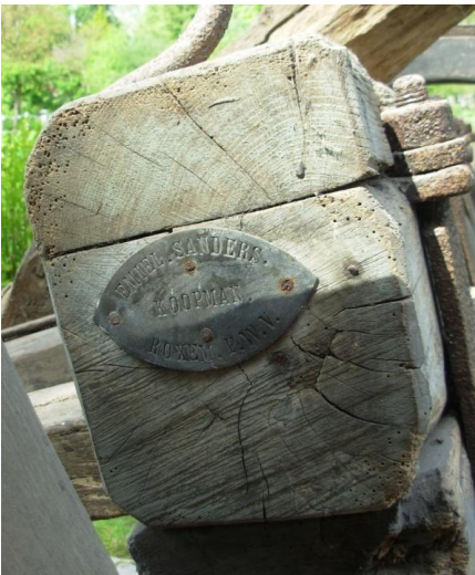
Links: Asblok met duidelijk het hart aanwezig in het hout. (inv. 25) Rechts: Het hart is hier merkbaar in de koppen van de dissel en de rechter schoor. (inv. 27)
