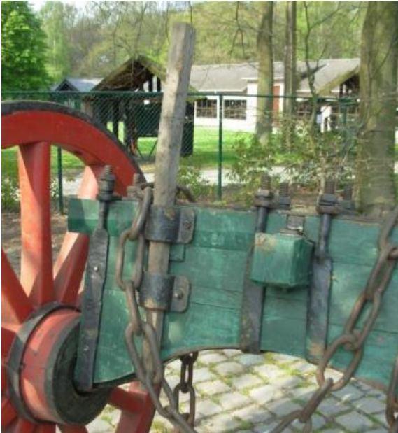
Links: Het vaste laadhout in twee beugels, links achteraan de asdam (inv. 12)
