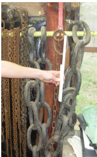
Links: Boomkettingen met schakels van ongeveer 19 cm. Karrenmuseum Essen Rechts: Tarra en brutto gewichten van een Oost-Vlaamse boomezel. (inv. 13)
