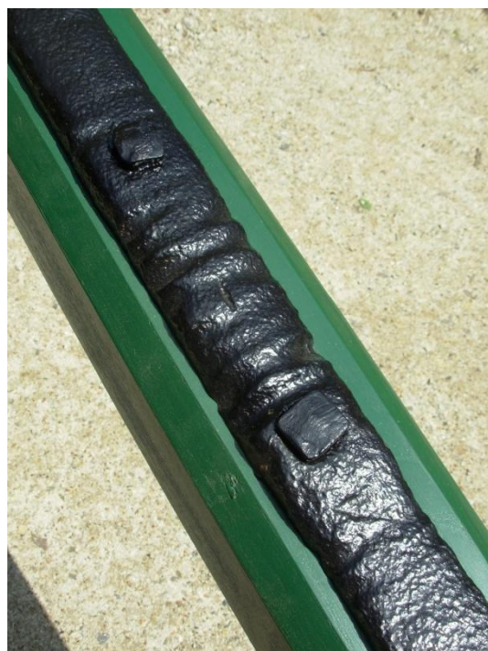
De sleetsporen van de woelketting op de ijzeren dissellat.
