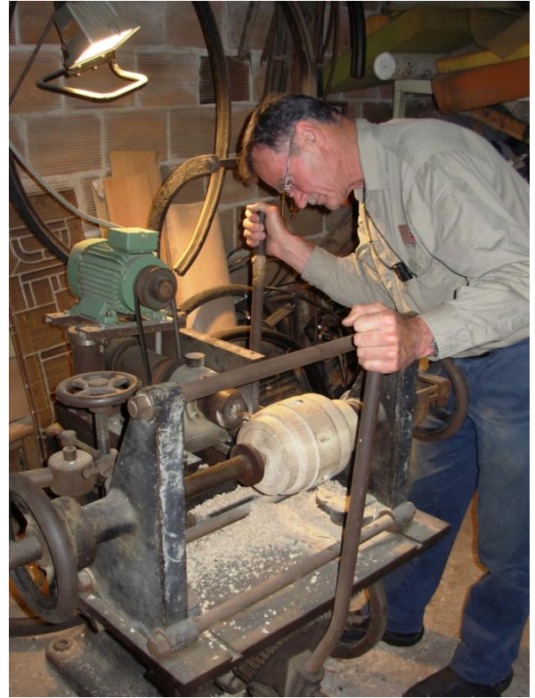
Gaten boren in de naaf.
