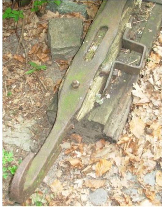
Links: sleepvoet in zijbeugel (inv. 4). Links en Rechts (inv. 14): zowel een gleuf in het disselijzer, maar niet meer in het disselhout, als een zijbeugel voor de sleepvoet.
