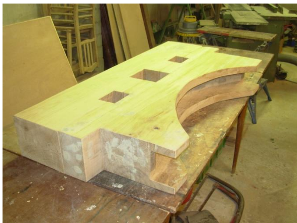
De vervaardiging van de asblok.
