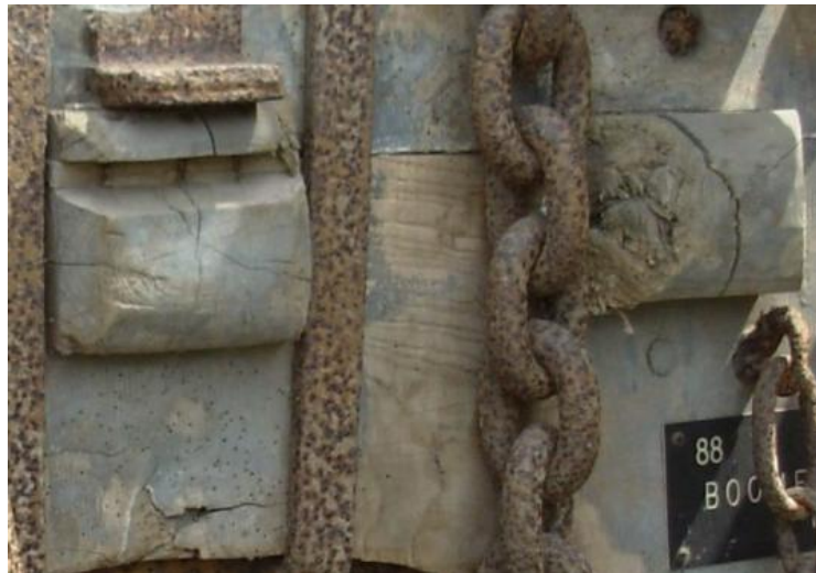
Links: Asblok met duidelijk het hart aanwezig in het hout. (inv. 25) Rechts: Het hart is hier merkbaar in de koppen van de dissel en de rechter schoor. (inv. 27)
