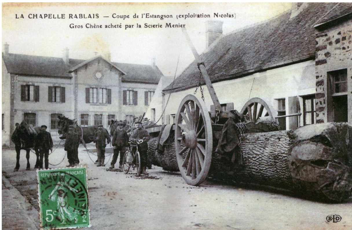
Foto: Boomezel met voorwaarts scharnierende strijkbalk te Chapelle Rablais. Wielen met 16 spaken en met een diameter van ongeveer 2,50 m. Omstreeks 1905-1910. Tijdschrift: Sabots 30, artikel: Rouler le bois, Deel 2.
