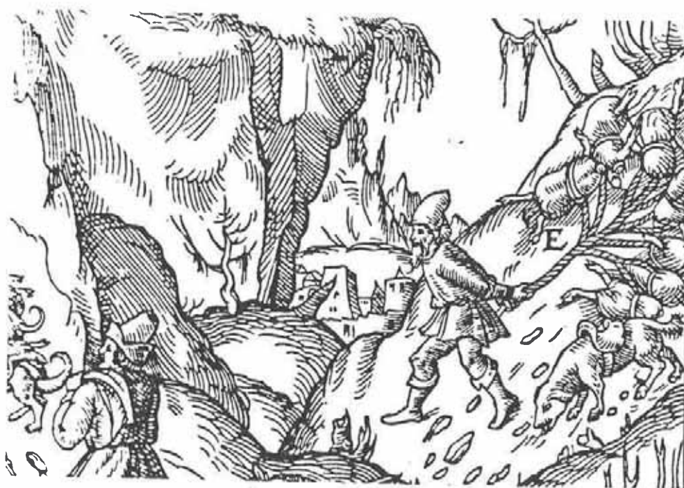
afb. 13 : erts in leren zakken naar het dal slepen (trainage de minerai dans des sacs de cuir; hauling of ore in leather saks)
