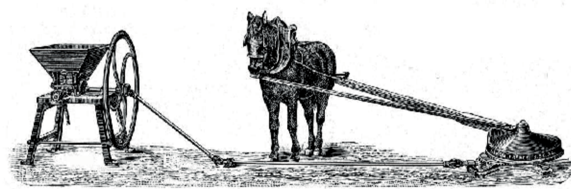
Metalen rosmolen die pletter aandrijft. Handelscatalogus Simon frères. Appareils de laiterie. N° L. 15, Cherbourg 1912-1913.
