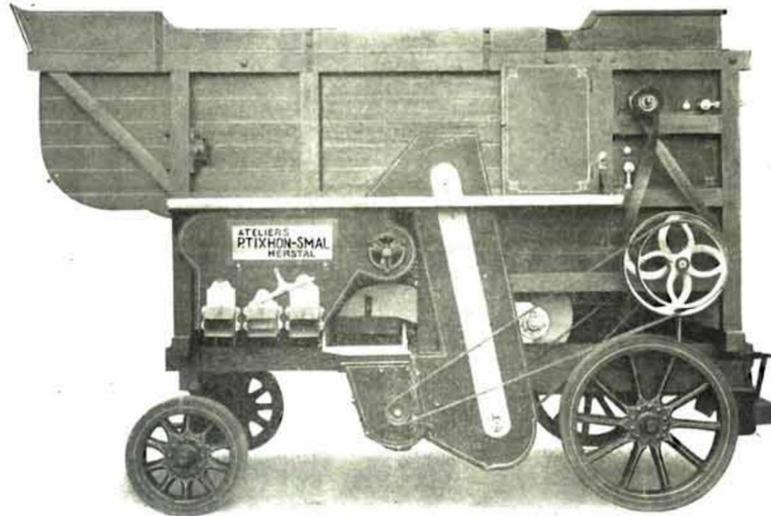
**Batteuse n° T 3 a** à long cylindre, battes cornières profilées et striées, coussinets à billes au batteur, secoueurs extra longs avec chute de paille en bout, cribles équilibrés, double nettoyage, ébarbeur réglable, ensacheur de balles, roues en bois ou en fer, frein.
