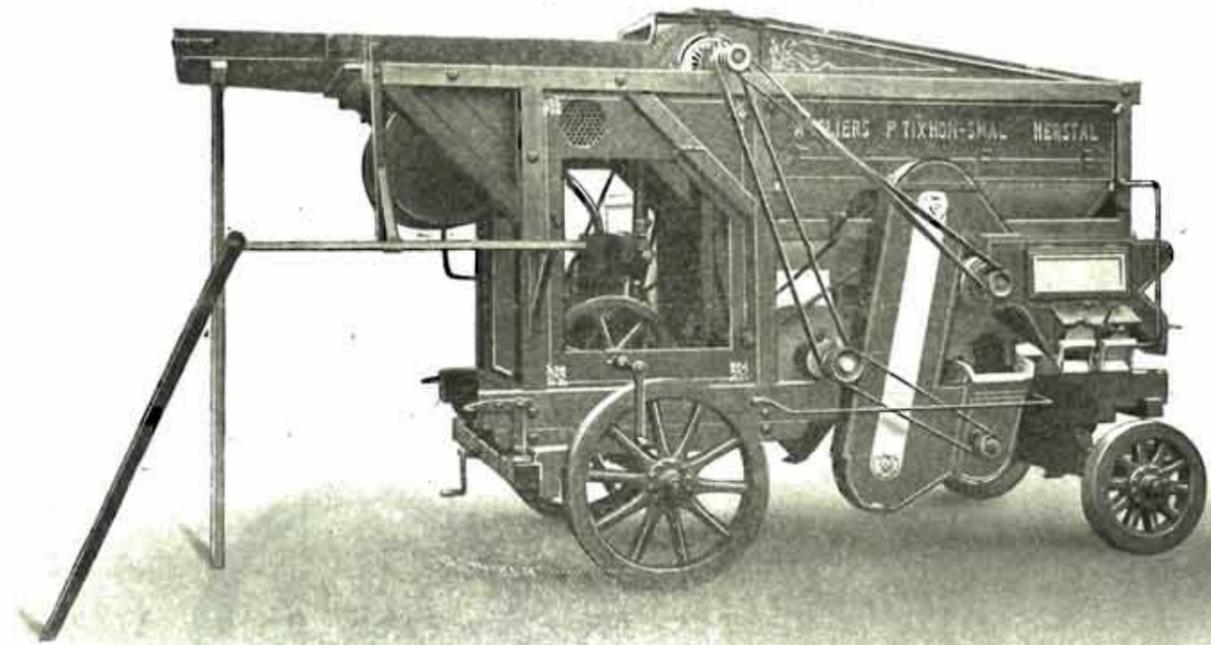
**Motobatteuse n° 3 a** avec moteur de 5 H P. — Débit 60 sacs. L'idéal pour l'entrepreneur de battages, 1 m. 80 de largeur intérieure, double nettoyage et ébarbeur réglable, réservoir à eau soudé au chalumeau oxydrique, fortes roues en bois ou en fer avec frein.
