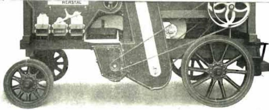
**Batteuse n° T 3 a** à long cylindre, battes cornières profilées et striées, coussinets à billes au batteur, secoueurs extra longs avec chute de paille en bout, cribles équilibrés, double nettoyage, ébarbeur réglable, ensacheur de balles, roues en bois ou en fer, frein.
