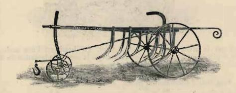
Cet EXTIRPATEUR est destiné à fonctionner dans un sol durci qu'il doit ameublir pour le rendre propre à l'a r atmosphérique mais sans retourner la terre, sans ramener à la surface les mauvaises herbes et les fumiers que la charrue a retourné dans le fond du sillon. Il convient pour déchaumer et détruire les mauvaises herbes.
