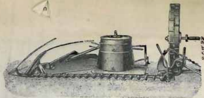
Vue du „MERVEILLEUX", avec son diviseur posé sur la barre coupeuse
