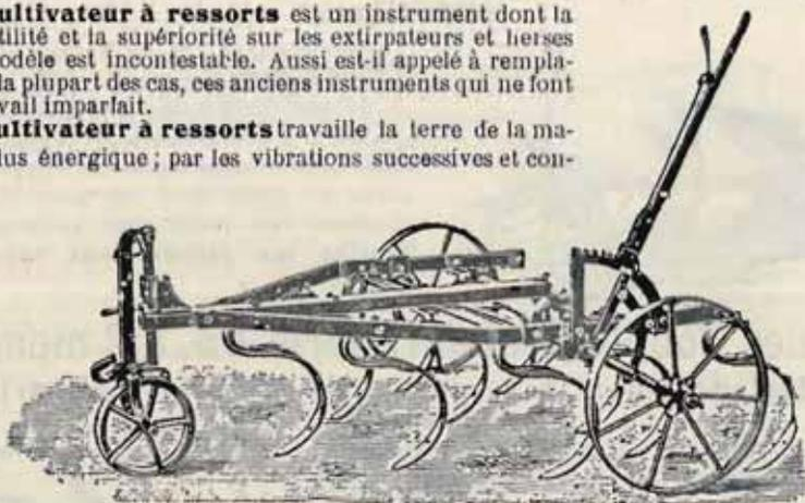
tinues des ressorts élastiques, il ouvre le sol, remue, secoue et mélange les terres à la perfection et les rend accessibles à l'air ; il rendra ainsi d'immenses services, au printemps notamment, dans le sol durci par les gelées d'hiver. Il arrache du sol et rejette à la surface, où ils périssent, toutes les mauvaises graines et les mauvaises herbes avec leurs racines, de sorte que les terres sont complètement nettoyées et préparées au mieux pour le semis.
