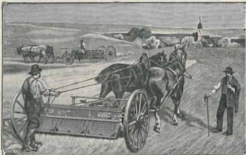
**Les quantités à distribuer** se règlent de façon très précise, par la largeur de l'ouverture de distribution et par la vitesse donnée à la chaîne et qu'on peut modifier au moyen de 4 jeux d'engrenages différents.
