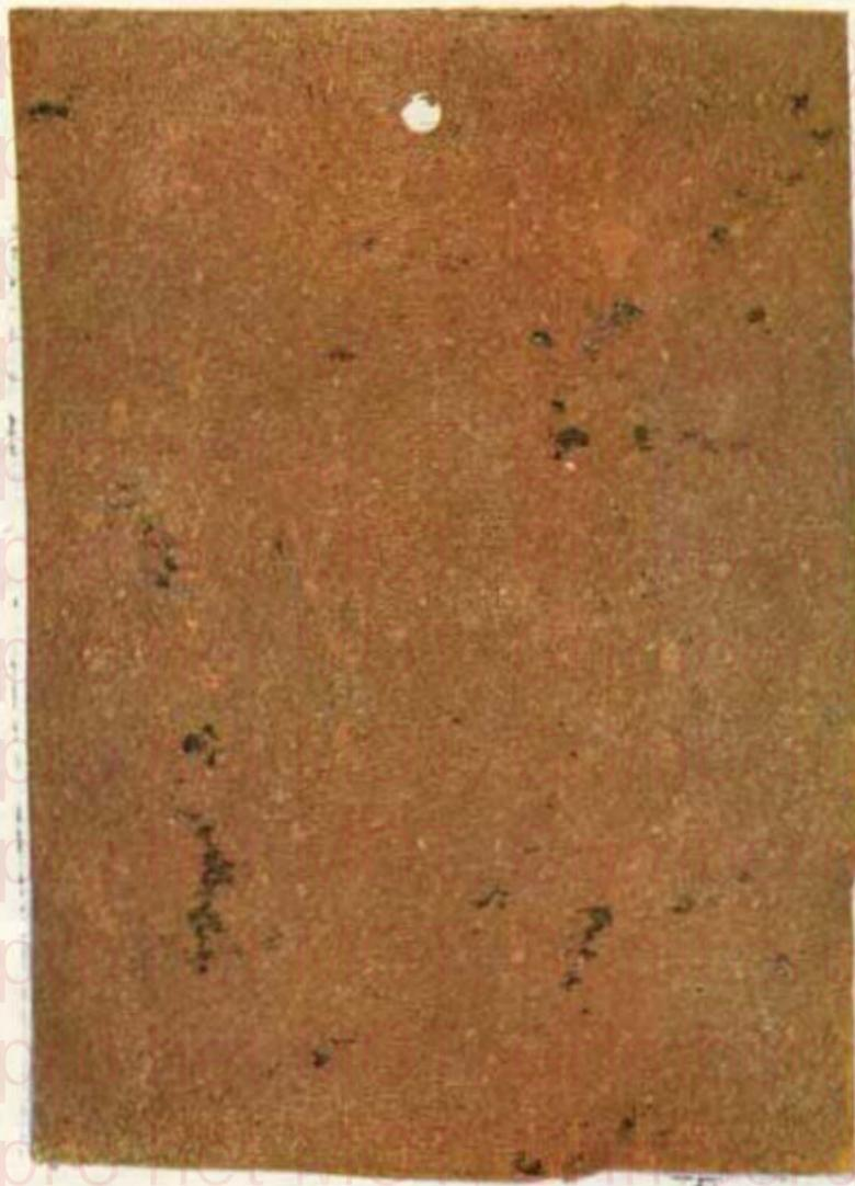
Plaque de fer exposée à des vapeurs acides et gaz sulfureux pendant 10 jours, dans un laboratoire de chimie.
