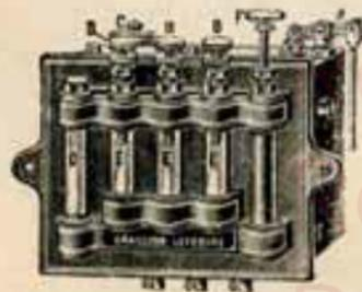
**Graisseurs** mécaniques à débits multiples
