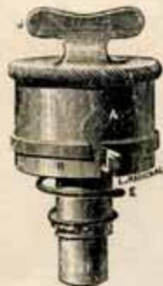
Graisseur à graisse consistante se fait à arrêt et automatique.
