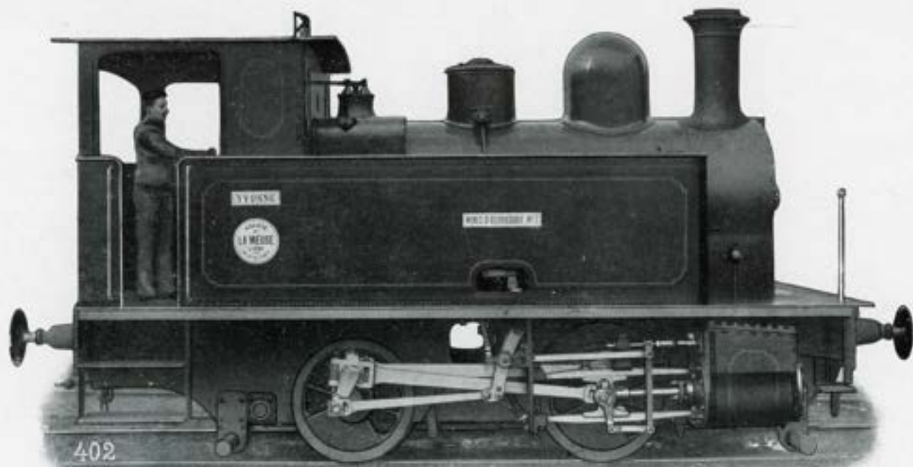
Locomotive-Tender à empattement très réduit de 2 m 000 pour fortes courbes
