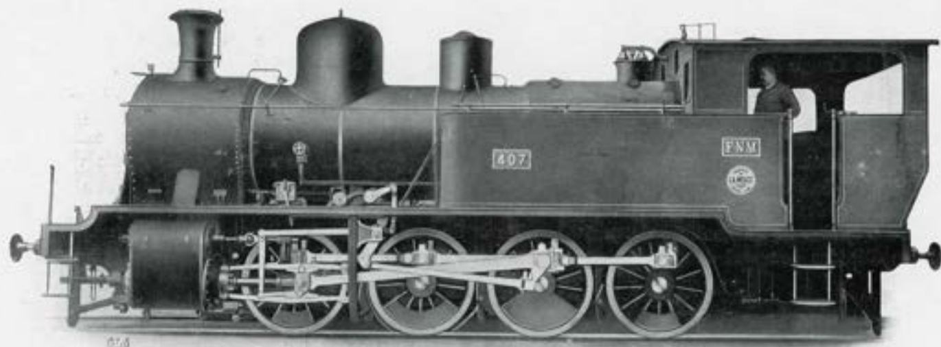
Locomotive-Tender à 8 roues couplées de 1 m 322 de diamètre et à vapeur surchauffée
