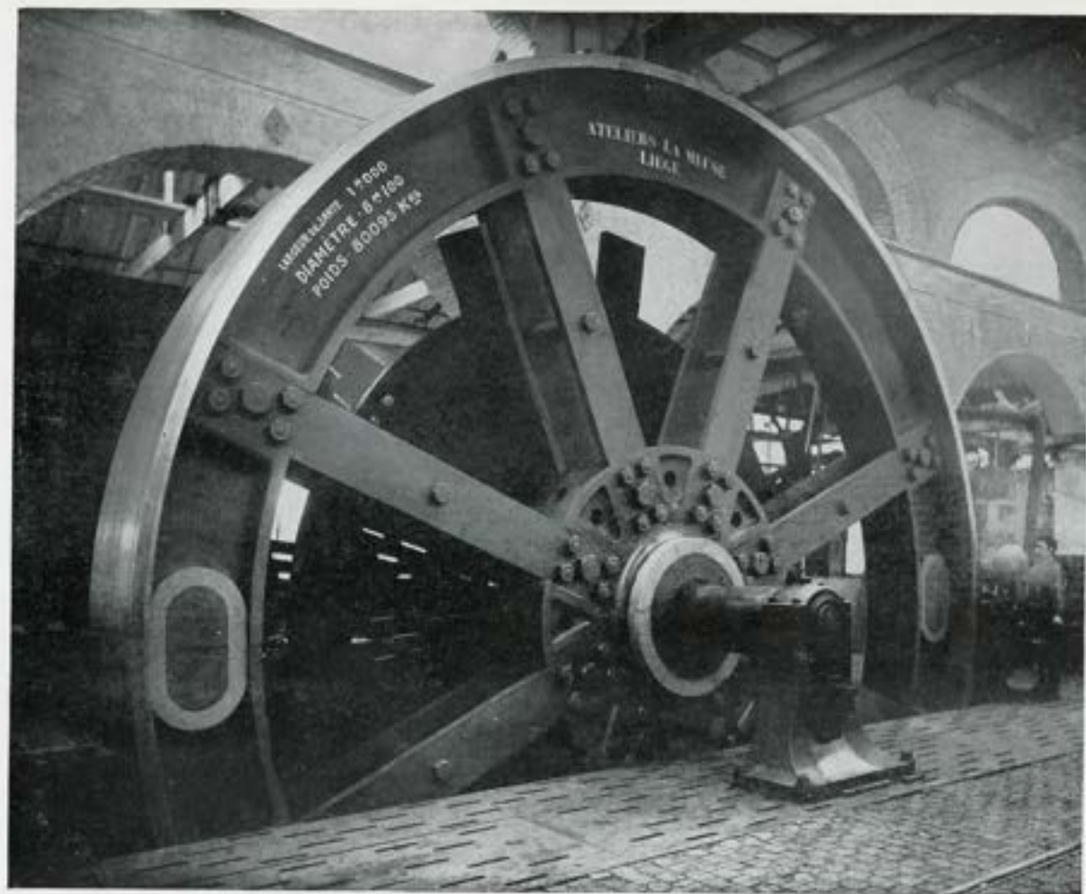
Volant de machine de laminoir en parachèvement dans l'atelier de tournage
