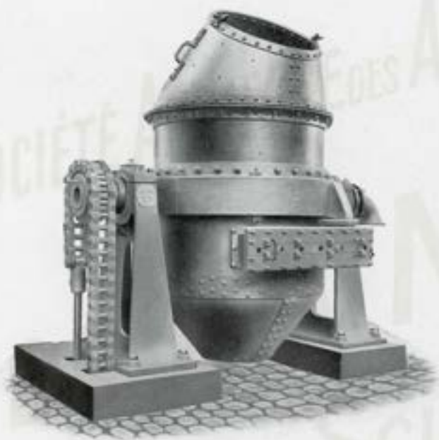
CONVERTISSEUR pour Fonderie d'Acier à renversement par cylindres hydrauliques et chaîne Galles.
