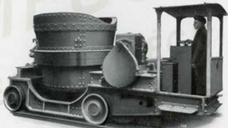
POCHES A FONTE montées sur chariots, avec commandes électriques ou à main.
