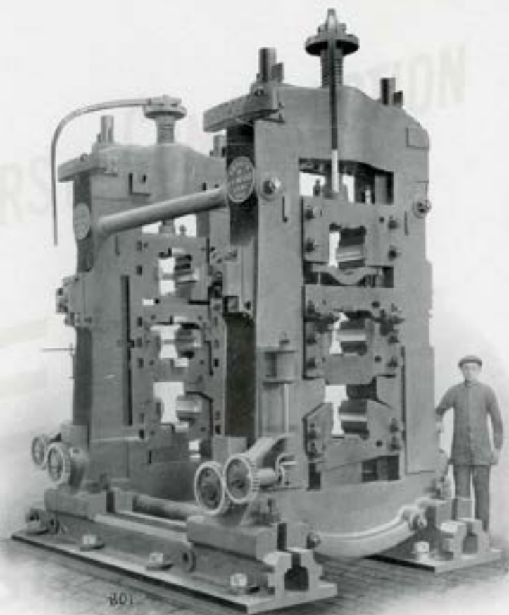
CAGE A PIGNONS et CAGE A CYLINDRES pour TRIO de 750 m/m.
