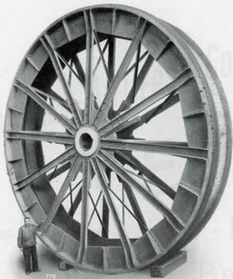
POULIE KOEPE de 7 mètres de diamètre.
