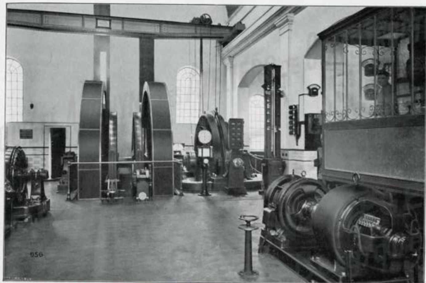
MACHINE D'EXTRACTION de LA MEUSE à commande directe par moteur électrique, avec appareil de sécurité breveté.
