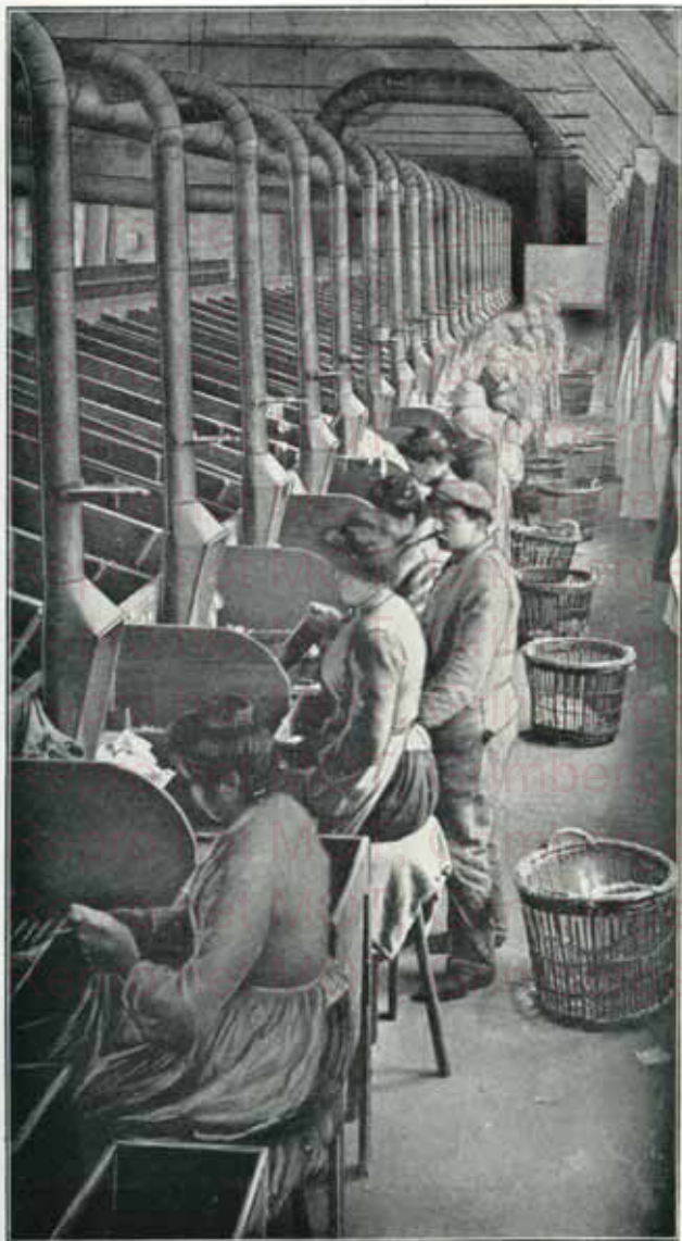
Aspiration de poussières dans l'atelier de défilage d'une Papeterie.
