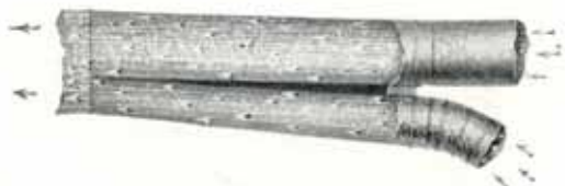
Vue en coupe d'un raccord breveté donnant un courant uniforme avec absence totale de remous.
