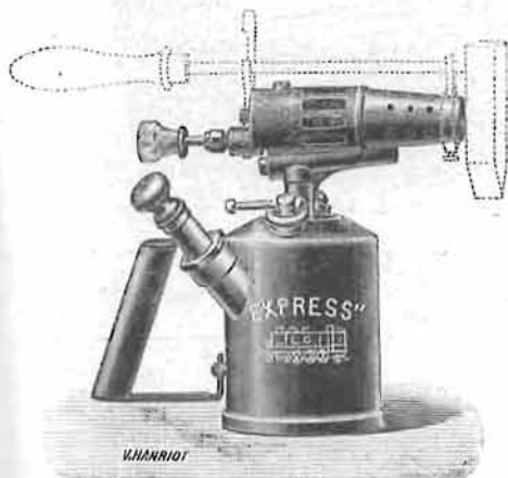
Lampe à braser "Express,, à pompe N° 352 Cont.: 1 litre — Durée de marche : 50 m.
