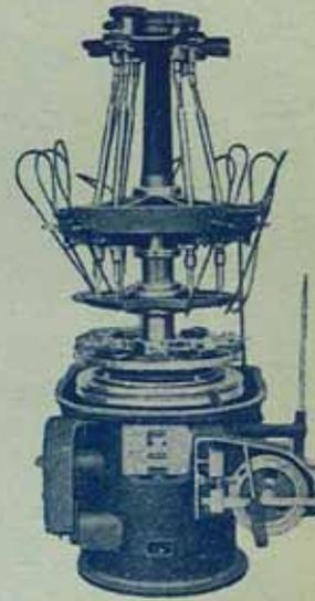
table horizontale, rotative permettant l'exécution automatique et consécutive de 5 à 9 travaux de forage distincts. Les broches peuvent être écartées et rapprochées à volonté. Le nombre de broches varie à la demande.
