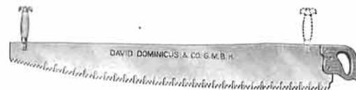
N° 1670 Scie à tronçonner, forme St-Joseph, avec poignée bois verni fixée par 3 rivets, et munie au bout d'une monture bois permettant le travail à deux hommes, lame en acier au four électrique, entièrement polie, denture américaine, avoyée et affûtée, soigneusement dressée et trempée.
