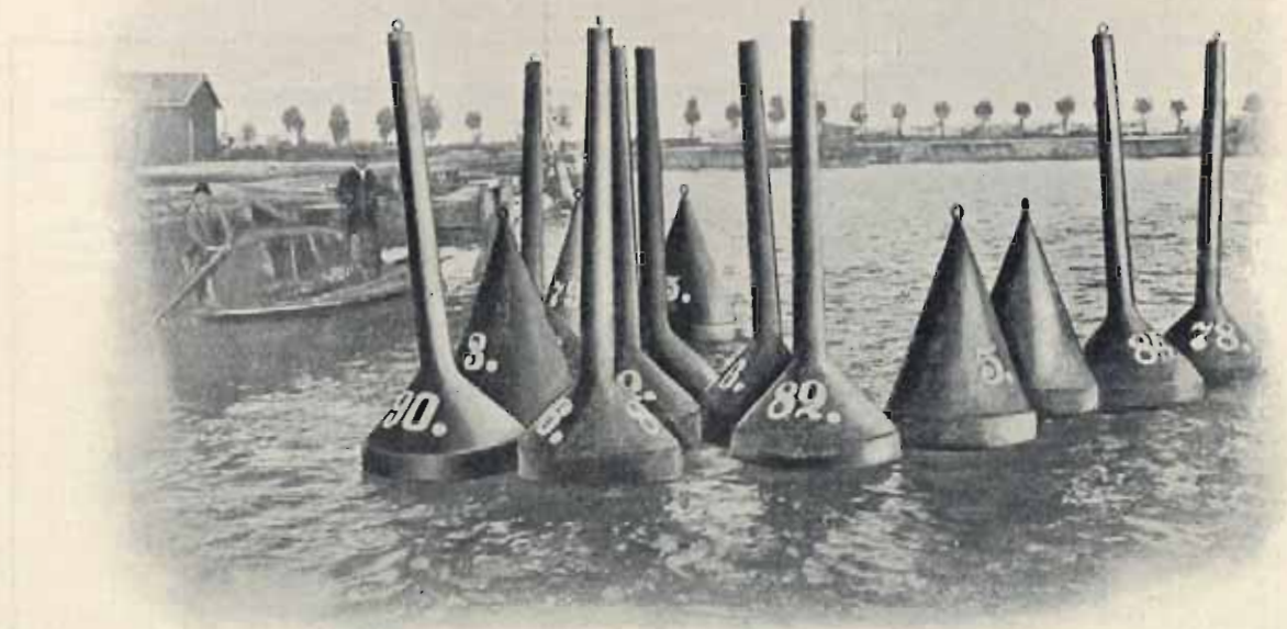
Société en commandite „Ferrum“, à Kattowitz. Bouées pointues et bouées espars, soudées à vide avec le gaz d'eau, système Dellwik-Fleischer, pour Pillau.
