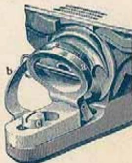
Le fil de la canette doit venir du dessous vers soi. Passez le fil par l'entaille qui traverse la navette et en tirant du côté fendu du ressort il se mettra seul sous le ressort.
