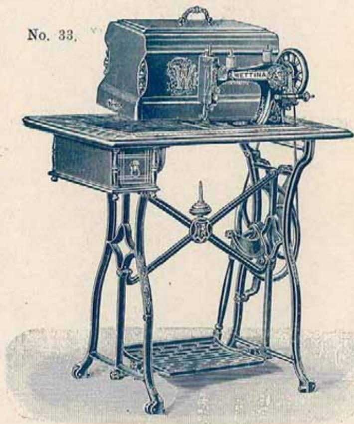
machine à navette vibrante (V. S.)
