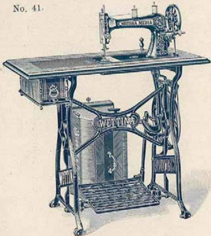
machine à navette vibrante (V. S.)
