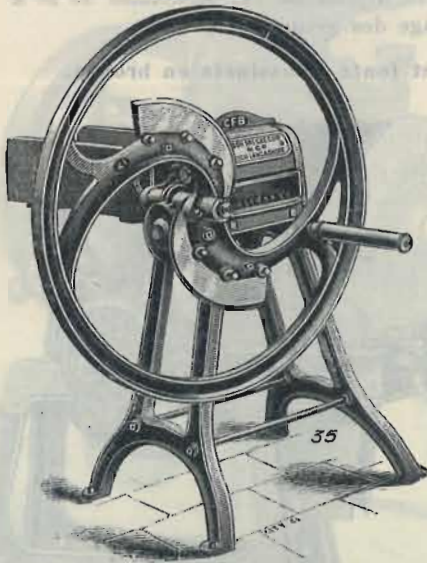
Modèle BF, coupant 2 long., bouche de 19 cm. Diamètre du volant 1 mèt. Poids approx. 100 kg. Prix : Fr. 70.—.
