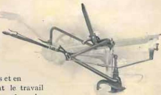
la barre d'une manière très facile à la hauteur et à l'angle nécessaires, le ressort compensateur soutenant le poids de la barre de pousse et de l'appareil de coupe. Des leviers d'inclinaison et de relevage bien à la portée du conducteur assurent le meilleur ajustement possible; et des crochets d'ajustage régularisent la tension du ressort de relevage et soulagent la chaîne. Notez également la tringle ajustable du levier d'inclinaison, fabriquée en deux pièces avec écrou double les assemblant.
