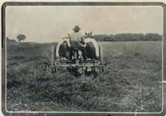
La traction se fait par les deux roues à la fois, sur la chaîne placée au milieu. Il y a trois jeux de roulements à galets sur l'essieu principal, ce qui réduit la traction. Les fourches sont à quatre dents en acier spécial trempé, et elles ont chacune un ressort amortisseur. Les fourches extérieures remuent le fourrage sur le passage des roues.
