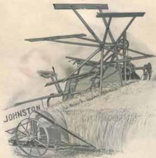
QUAND on règle la position du rabatteur, un fort ressort compensateur porte le poids de l'appareil, et aide la manoeuvre des leviers.
