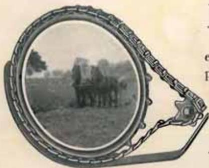
**L**A page opposée démontre pratiquement la vue de face et d'arrière des faucheuses Nos. 9 et 10. La seule différence est, que la faucheuse No. 9 est actionnée par une chaîne et la faucheuse No. 10 par un engrenage. L'acheteur peut faire son choix. La chaîne motrice de la faucheuse No. 9 se compose de mailles malléables très solides. Ces mailles ont une forme spéciale; au moyen d'un tendeur de chaîne ajustable, la tension de la chaîne est maintenue d'une
