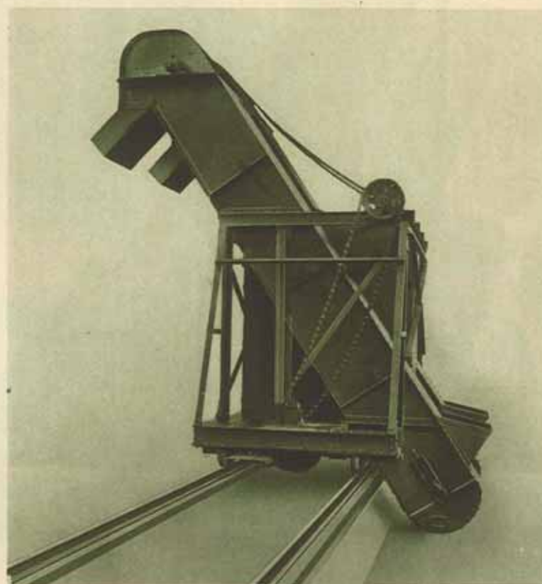
Double élévateur roulant sur rails.
