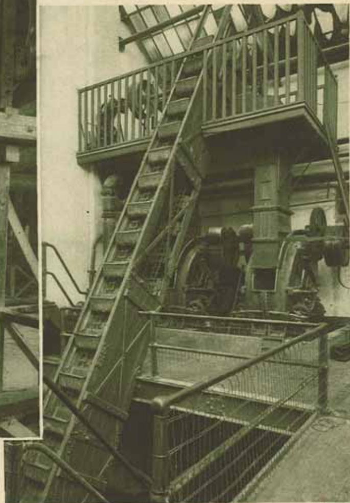
Elévateur incliné type « Drague » pour pulpes humides.
