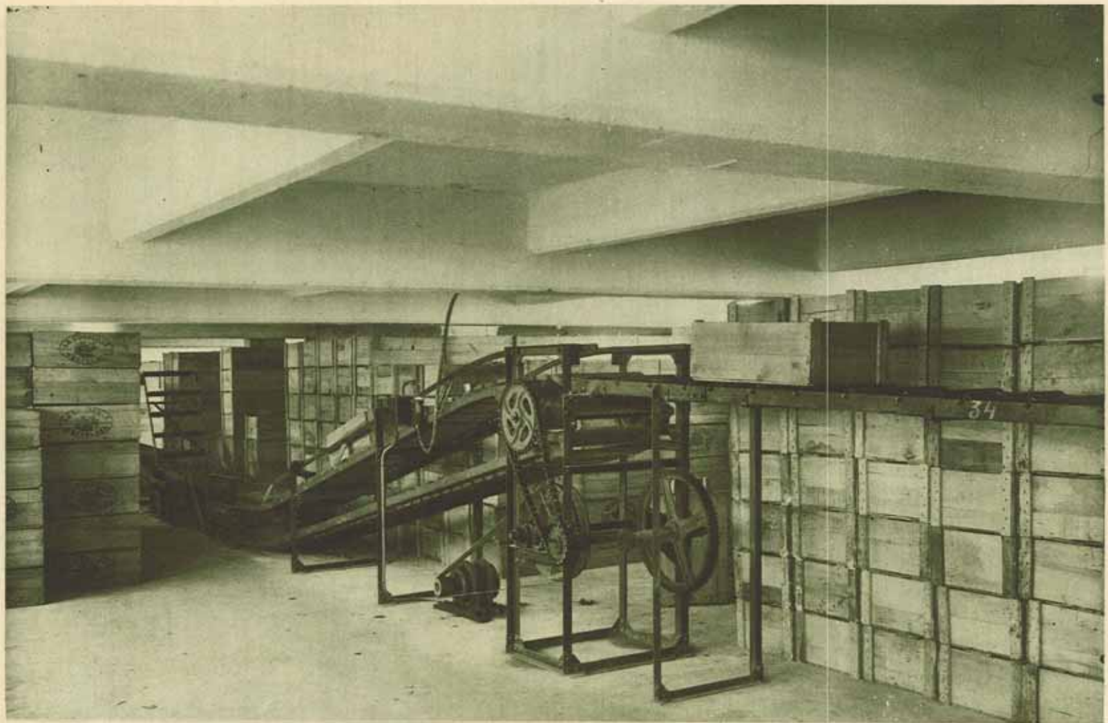
Elévateur-Transporteur, dit « Releveur », destiné à redonner de la hauteur aux colis afin de couvrir une plus grande distance sur transporteur par « Gravité ».
