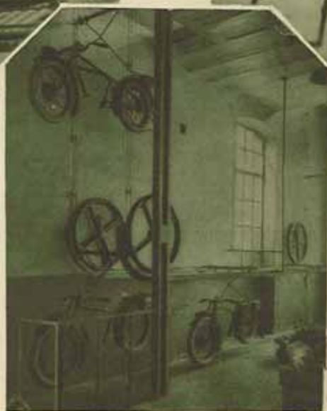
Manutention de motocyclettes en cours de montage, système « Chaîne Câblée »
