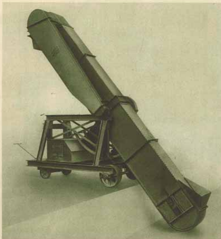
Elévateur à inclinaison variable et roulant sur le sol.
