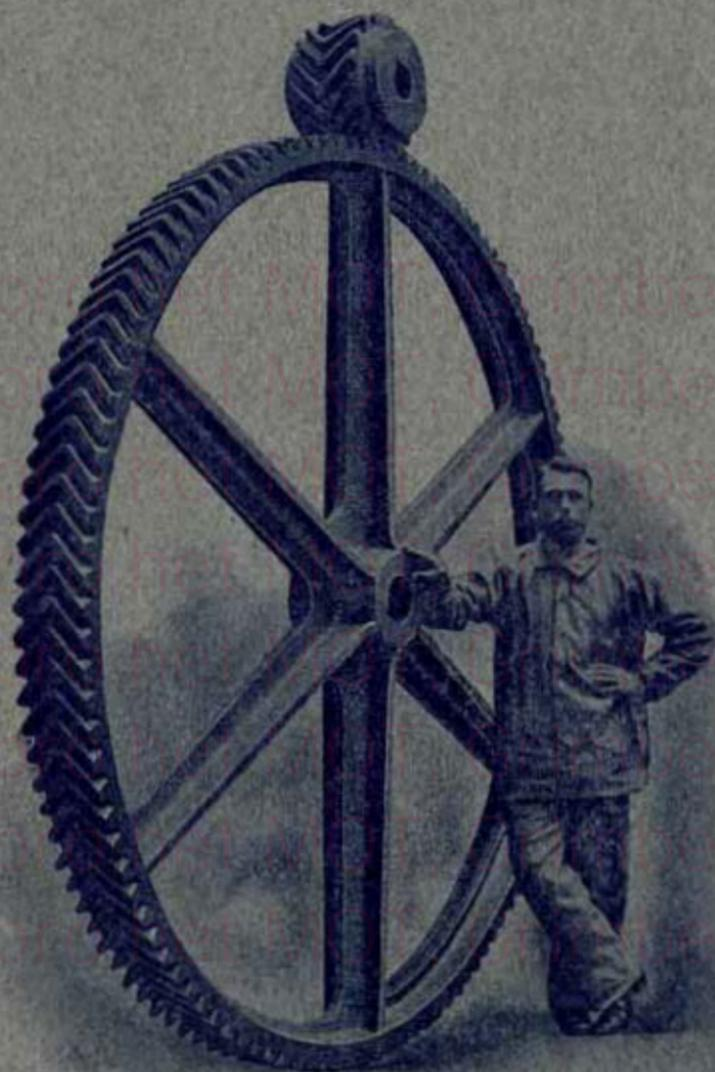
**Engrenages** en fonte transmettant 220 chevaux à une vitesse périphérique de 12 mètres par seconde. — Diamètres primitifs 2<sup>es</sup> 236 et 345 millimètres. — 118 et 87 dents de 180 millimètres de largeur.
