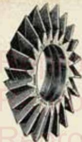
Spéciales pour tailler les fraises hélicoïdales. Elles sont à l'angle de 53°, 48° ou 30° d'un côté et à 12° de l'autre. L'angle de 53° est généralement adopté pour toutes les fraises sauf pour les petites dimensions et les fraises à denture très fine. Nous fournissons ces fraises à droite ou à gauche aux mêmes prix.
