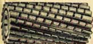
Denture fraisée. S'emploient principalement pour travaux à grand débit et pour dégrossir les pièces. La denture interrompue brise les copeaux, ce qui facilite la coupe et permet une lubrification plus parfaite.
