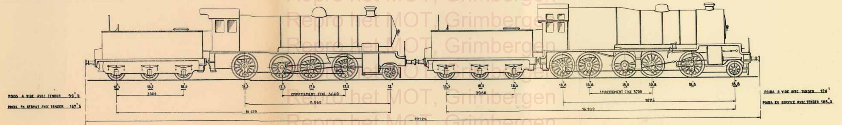
CHARGE REMORQUEE PAR UNE TYPE 31 ET UNE TYPE 36 SUR LE PARCOURS SCHARBEEK - LIBRAMONT = 1150 TONNES
