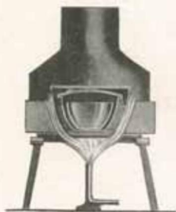
une flamme très chaude enveloppant entièrement le creuset extérieur, et l'on chauffe jusqu'à disparition complète de l'huile. Il ne reste alors au fond du creuset central qu'un résidu noir qu'on pèse avec précision. Le poids de ce résidu, exprimé en pourcentage et rapporté au poids de l'huile employée pour l'essai, donne l'indice de carbone résiduel.
