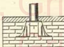
N° 796. Fondations poteaux
