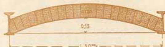
*Expériences.* Plusieurs essais ont été faits dans l'intention de préciser la force de résistance des voûtes maçonnées en briques de **quercine**. On a opéré sur une voûte, maçonnée en **quercine-noire**, d'après la figure 14, ci-dessus. Voici les résultats :
