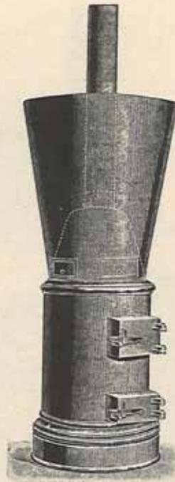
N° 141. — Four à sécher le sable pour motrices, hauteur du poêle 1 m. 55, réservoir compris 2 m., diamètre 0 m. 75, poids 400 kilos. Sert en même temps à chauffer l'atelier. Prix sur demande.
