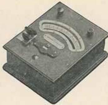
Ampèremètre électrodynamométrique. 5 amp.
