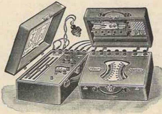
Appareil de compensation étalon pour le réétalonnage
