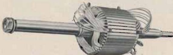
FIG. 8. — Induit en cours de bobinage.
