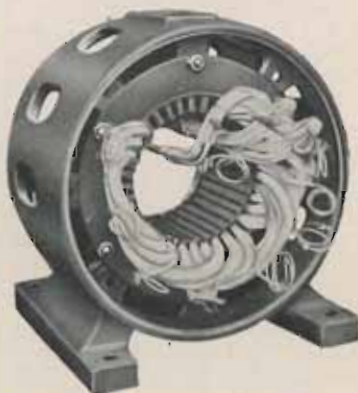
FIG. 7. — Carcasse en cours de bobinage.
