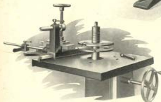
PENNENAPPARAAT OP DE FRAISMACHINE Hoogste toerental : 2500.
