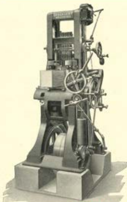
VERTIKALE RAAMZAAGMACHINE voor hout tot 290 x 450.
