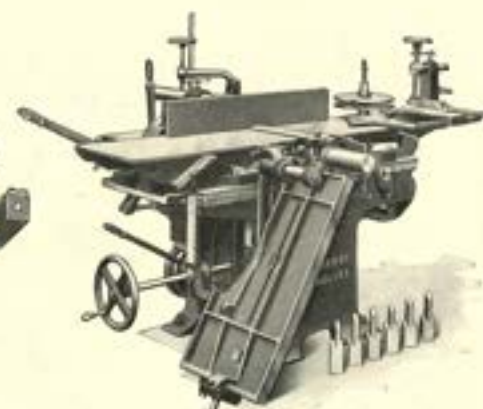
APPARAAT VOOR HET MAKEN VAN PENNEN die geplaatst kan worden op gecombineerde met verticale frais.
