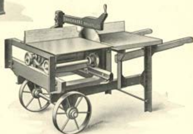
ELECTRISCHE AFKORTZAAGMACHINE VERVOERBAAR MODEL Ruimte voor de liniaal : 675 m/m.
