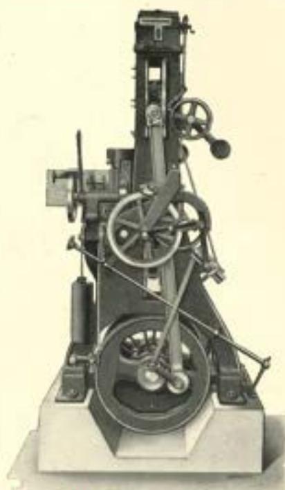
VERTIKALE RAAMZAAGMACHINE voor hout tot 290 x 450.
