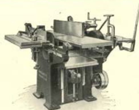
UNIVERSEELE GECOMBINEERDE bestaat uit een vlakbank, vandiktebank, langgatboor, apparaat om moeluren te maken en cirkelzaag.
