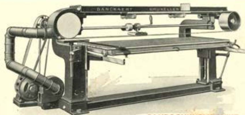
BANDSCHUURMACHINE Met gebogen frame. Met tafel van 2.250 \times 0.930 m.
