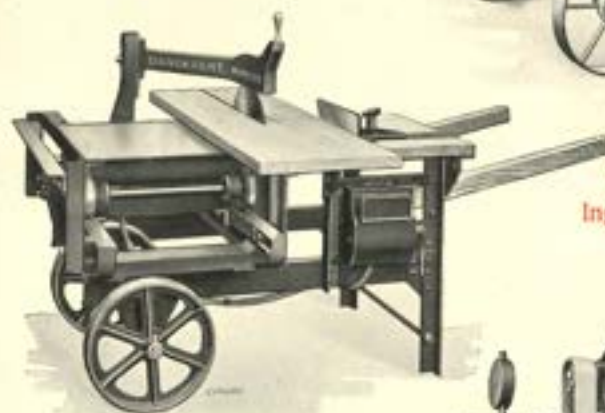
ELECTRISCHE AFKORTZAAGMACHINE VERVOERBAAR MODEL Ruimte voor de liniaal : 675 m/m.
