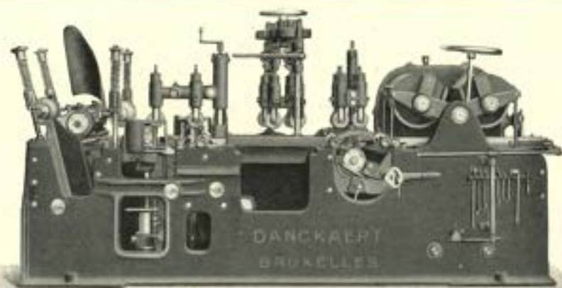
VIERZIJDIGE SCHAAFMACHINE MET 4 ASSEN EN VASTE MESSEN voor hout tot 275 \times 125 en 375 \times 125 . Kan worden geleverd met kraalblok.
