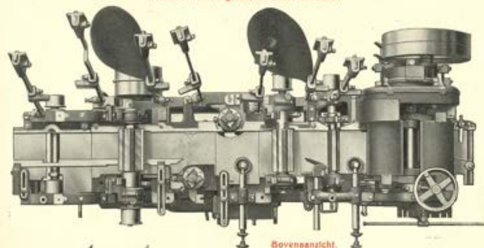
LIJSTENSCHAAFMACHINE MET ZES BEITELASSEN voor hout tot 275 × 125 en 375 × 125 4 AANVOERSNELHEDEN Kan ook worden geleverd zonder kraalblok.
