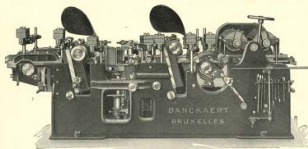
LIJSTENSCHAAFMACHINE MET ZES BEITELASSEN voor hout tot 275 × 125 en 375 × 125 4 AANVOERSNELHEDEN Kan ook worden geleverd zonder kraalblok.
