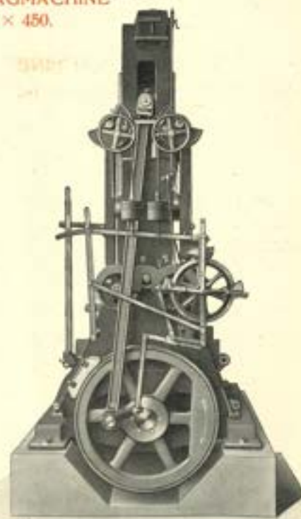
VERTIKALE RAAMZAAGMACHINE voor hout tot 1.100 x 1.050 m.
