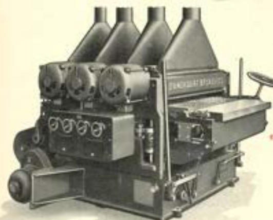
SCHUURMACHINE MET DRIE CYLINDERS AANVOER DOOR TAPEL ZONDER EINDE Voor hout tot : 1.014 \times 0.15 m. en 1270 \times 0.15 m.
