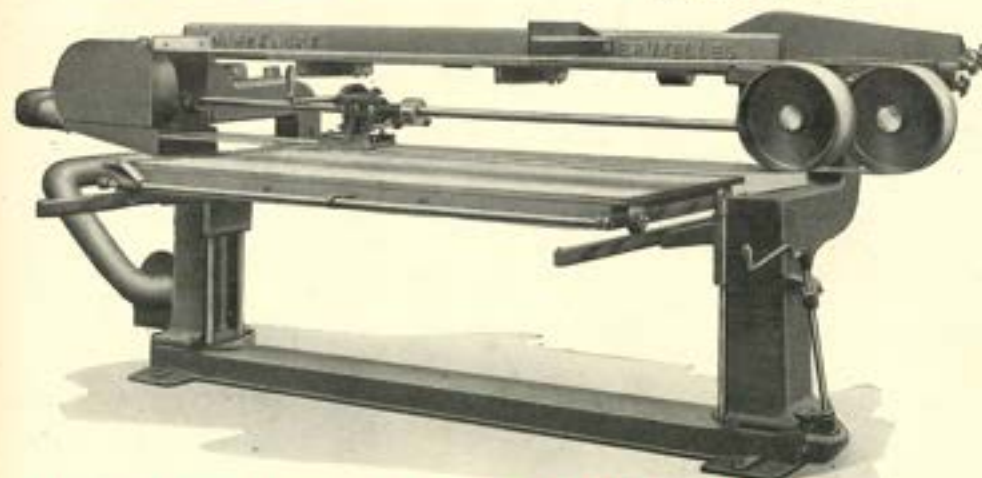
BANDSCHUURMACHINE MET TWEE SCHUURBANDEN Rollende tafel van 2.250 \times 0.930 m.
