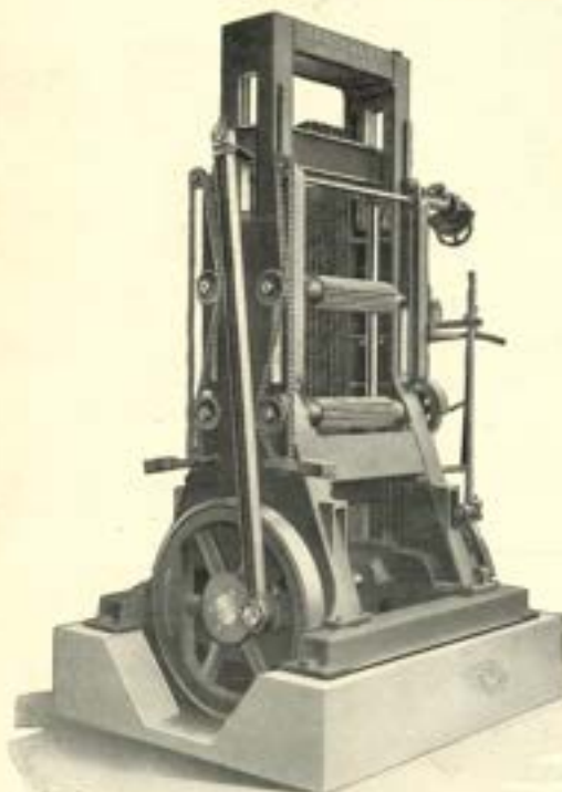
VERTIKALE RAAMZAAGMACHINE voor hout tot 1.100 x 1.050 m.
